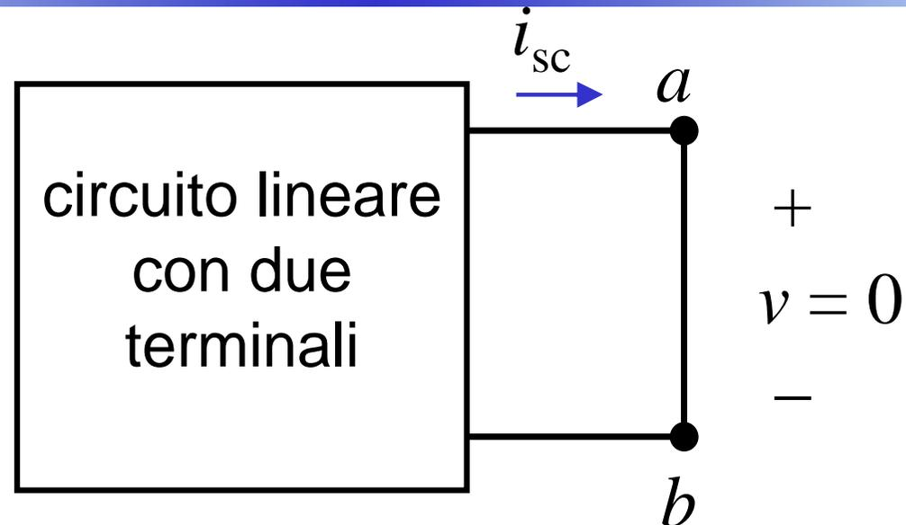
$I_N$  coincide con la corrente di corto circuito del circuito:  $I_N = i_{sc}$
