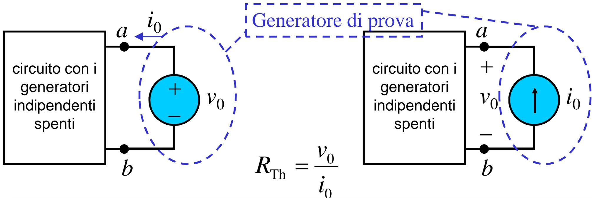
$R_{Th}$  coincide con il rapporto tensione/corrente ai terminali  $ab$  (corrente entrante nel circuito)
