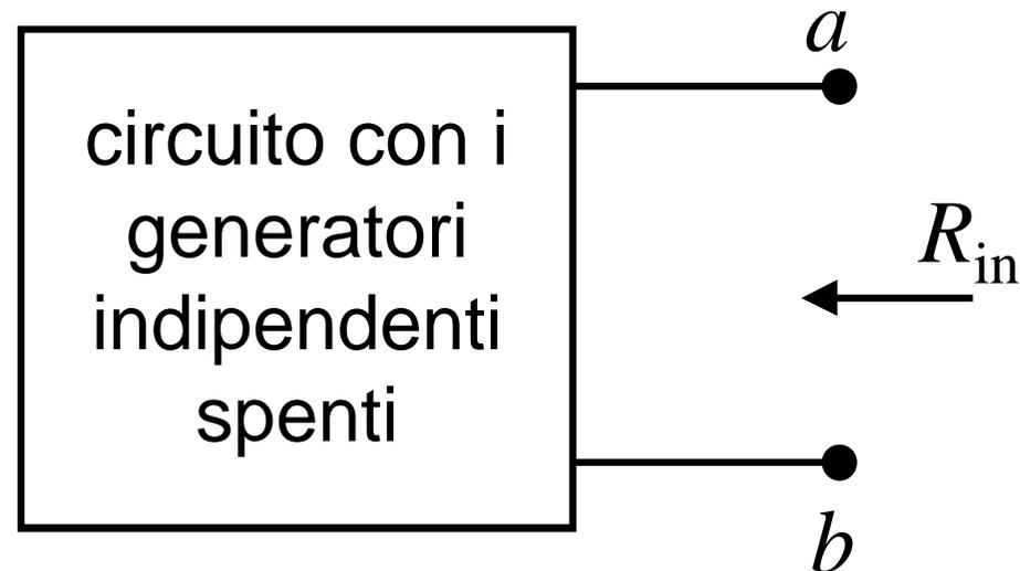
$R_{Th}$  coincide con la resistenza  $R_{in}$  vista ai terminali  $ab$  dopo aver spento tutti i generatori:  $R_{Th} = R_{in}$
