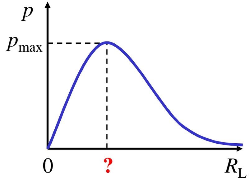
$$p = R_L \cdot i^2 = R_L \cdot \left( \frac{V_{Th}}{R_{Th} + R_L} \right)^2$$
