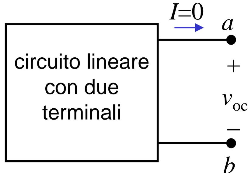
$V_{Th}$  coincide con la tensione a vuoto (circuito aperto ai terminali  $ab$ ) del circuito:  $V_{Th} = v_{oc}$
