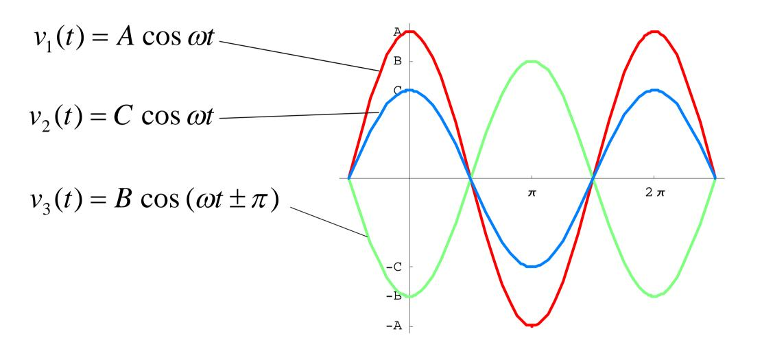
$v_1$  e  $v_2$  sono in fase,  $v_1$  e  $v_3$  sono in controfase
