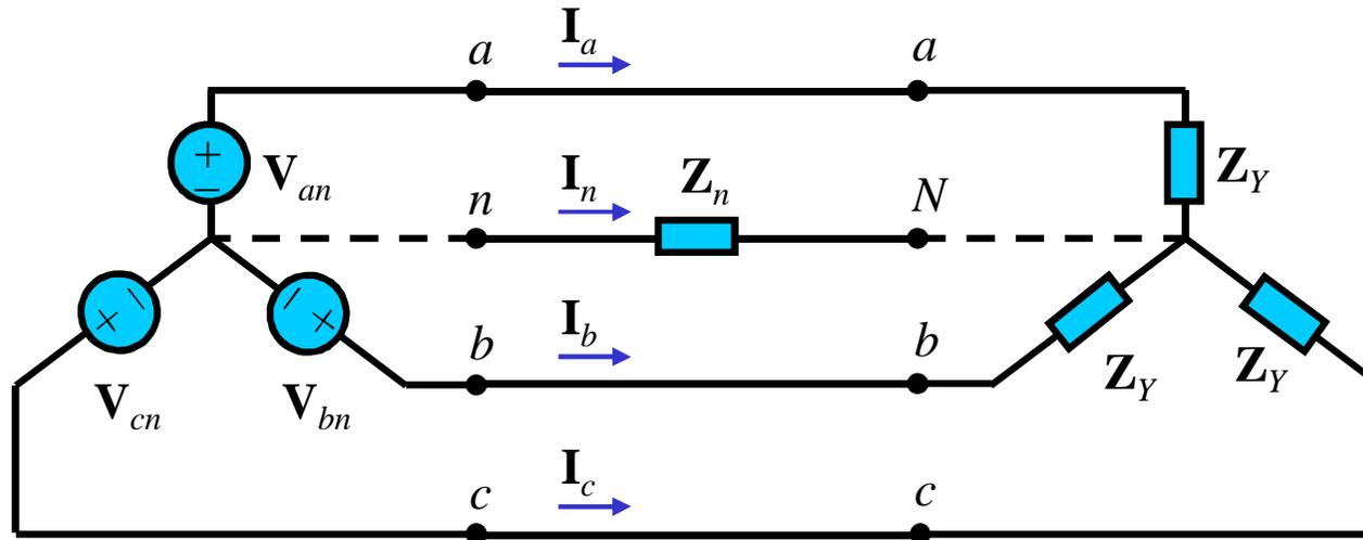
Poiché  $I_n = 0$ ,  $V_{nN} = 0$  si può rimuovere il *neutro* senza alterare il funzionamento del circuito:
