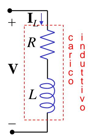
Trasferire la potenza P+jQ implica una corrente I lungo i fili di collegamento più intensa che non nel caso della sola potenza P.
