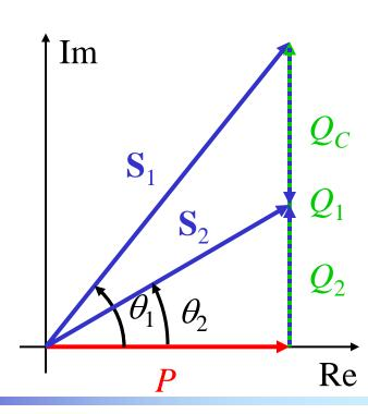
Il rifasamento riduce l'ampiezza della corrente in ingresso al carico ( $|\mathbf{I}| < |\mathbf{I}_L|$ ) a parità di potenza reale assorbita.
