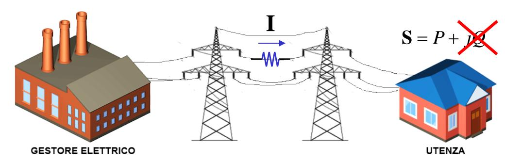
Il fattore di potenza può essere massimizzato introducendo una capacità in parallelo al carico.
