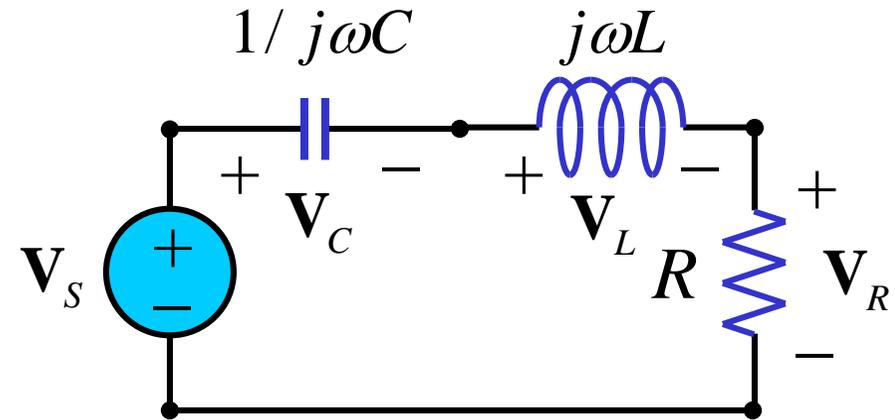
Le tensioni sul condensatore e sull'induttore sono uguali e opposte e nei circuiti ad alto fattore di merito possono raggiungere valori elevatissimi.
