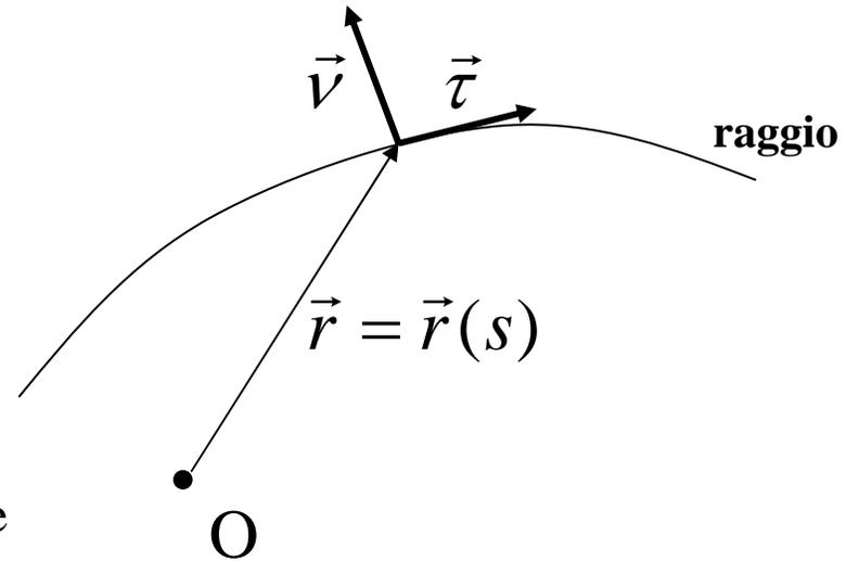
$$\vec{\tau} = \frac{\partial \vec{r}}{\partial s} \quad \text{direzione di propagazione}$$
